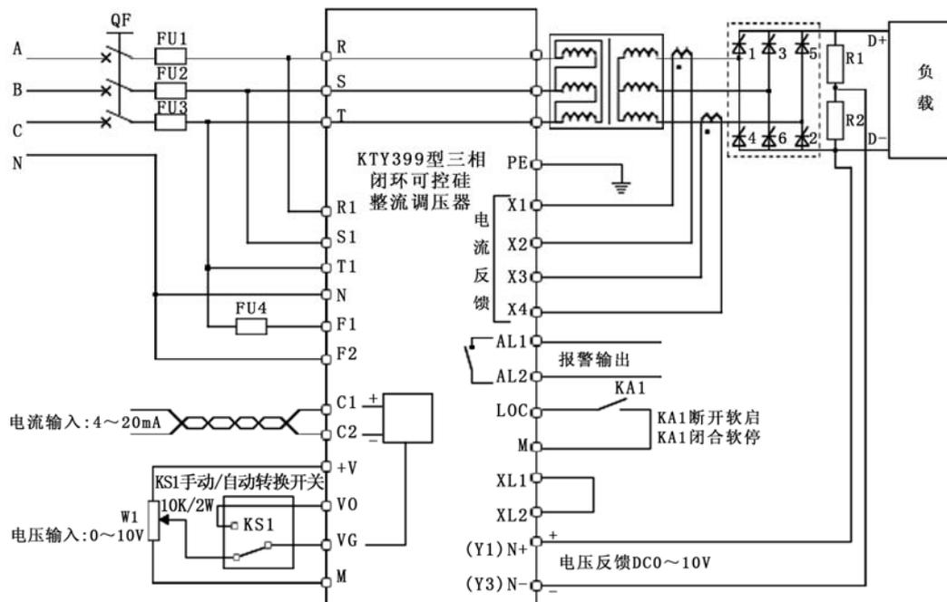
图 4-4-6 KTY399 应用于整流变压器副边可控硅全控整流电路低电压、大电流负载的闭环控制
