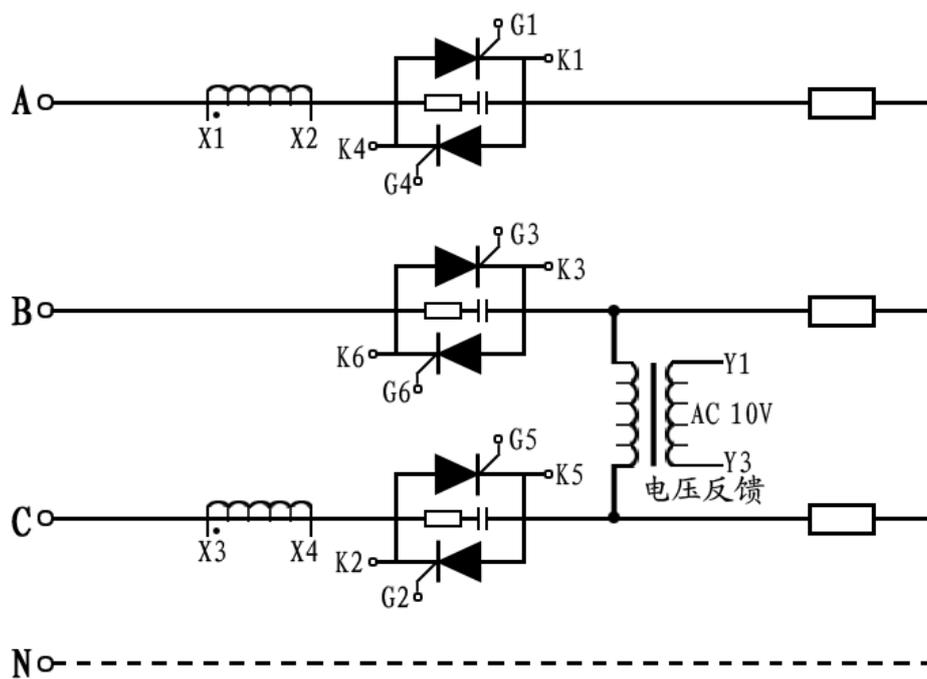
图4-2-2 星型负载接线图（星点可回零线亦可不回零线）
