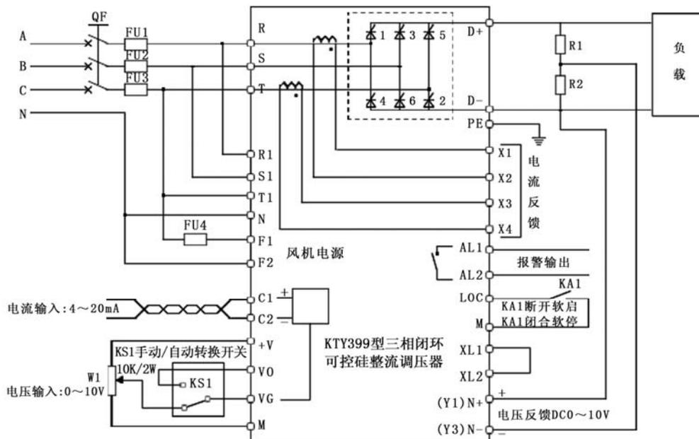
图4-4-5 KTY399应用于可控硅整流电路低电压、大电流负载的闭环控制
