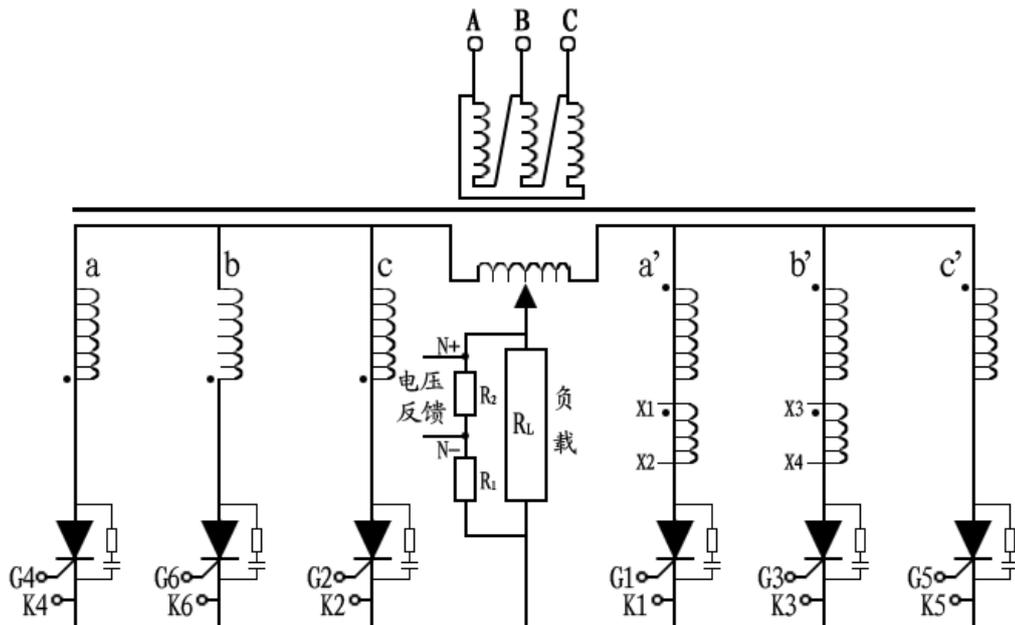
图 4-3-3 带平衡电抗器的双反 Y 型整流调压接线图
