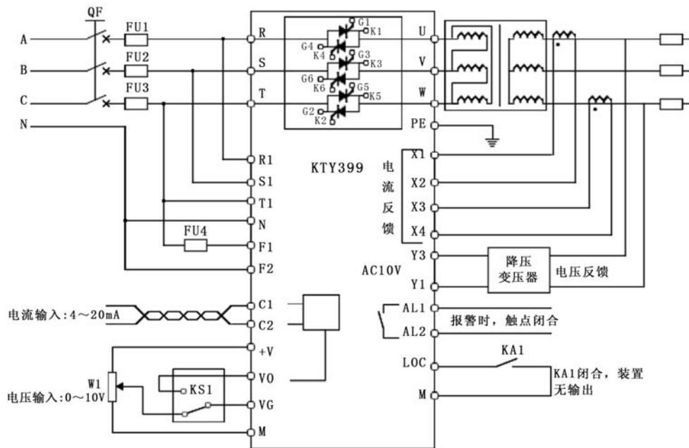
图4-4-4 KTY399应用于低电压、大电流负载的功率闭环控制
