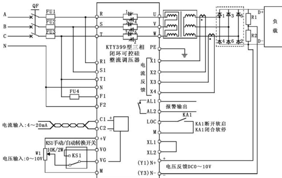
图4-4-7 KTY399应用于整流变压器原边交流调压、副边二极管整流主电路低电压、大电流负载的闭环控制
