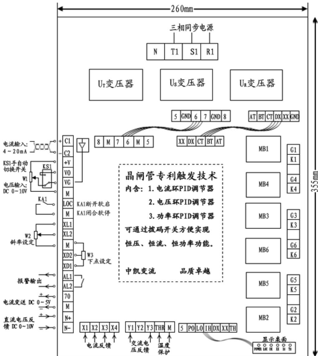
图4-1-1 KTY399型晶闸管触发板端子图
