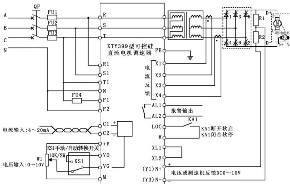
图4-4-9 应用于大功率变压器隔离型直流调速主电路接线控制系统示意图
