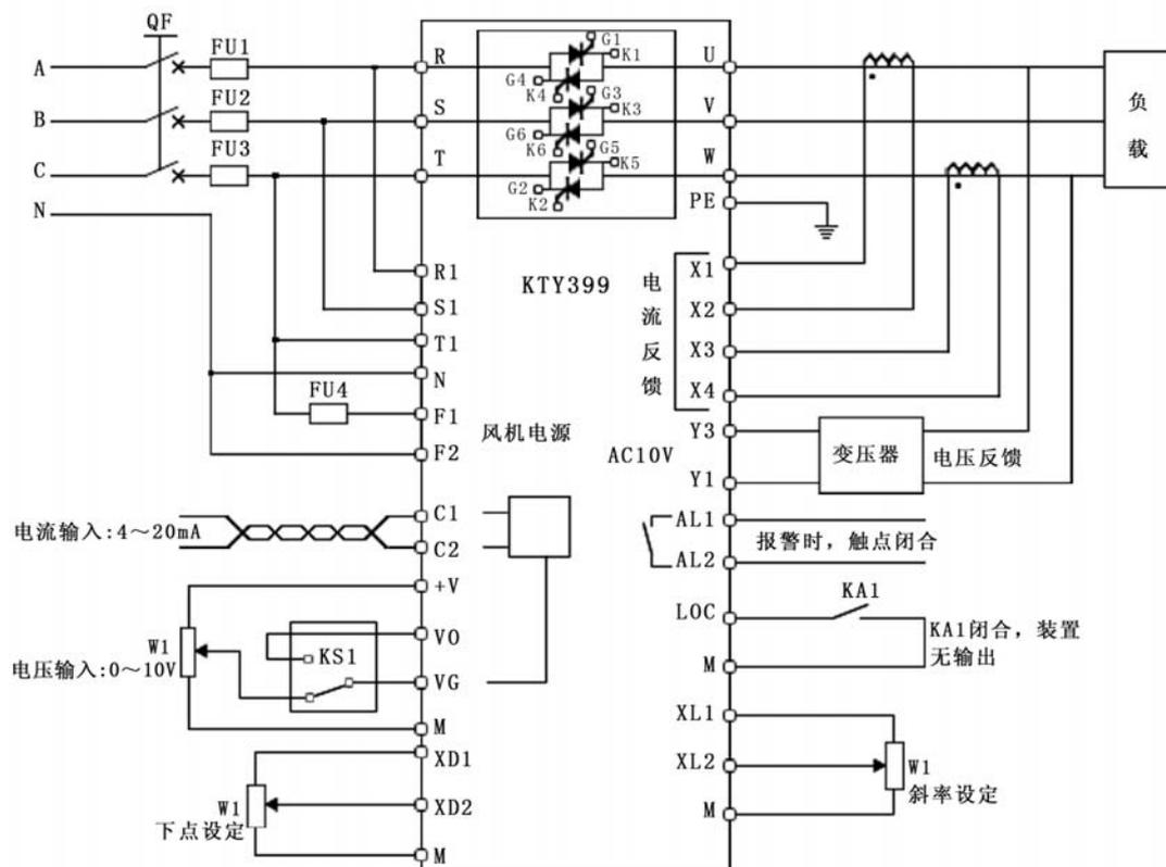
图4-4-1 基本控制接线
