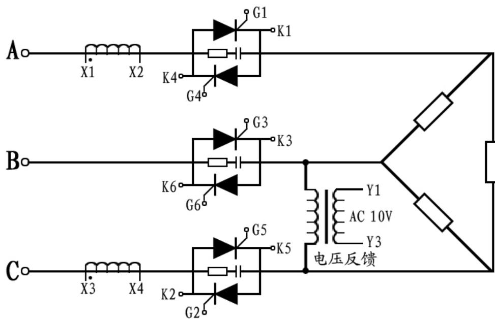
图4-2-1 三角型负载接线图
