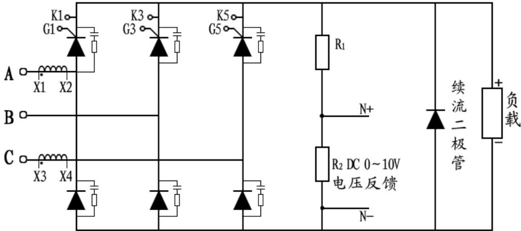
图 4-3-1 三相半控桥式整流调压接线图
