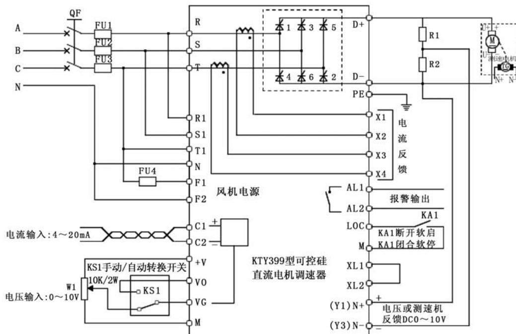
图 4-4-8 应用于三相全控整流直流电机调速基本接线图
