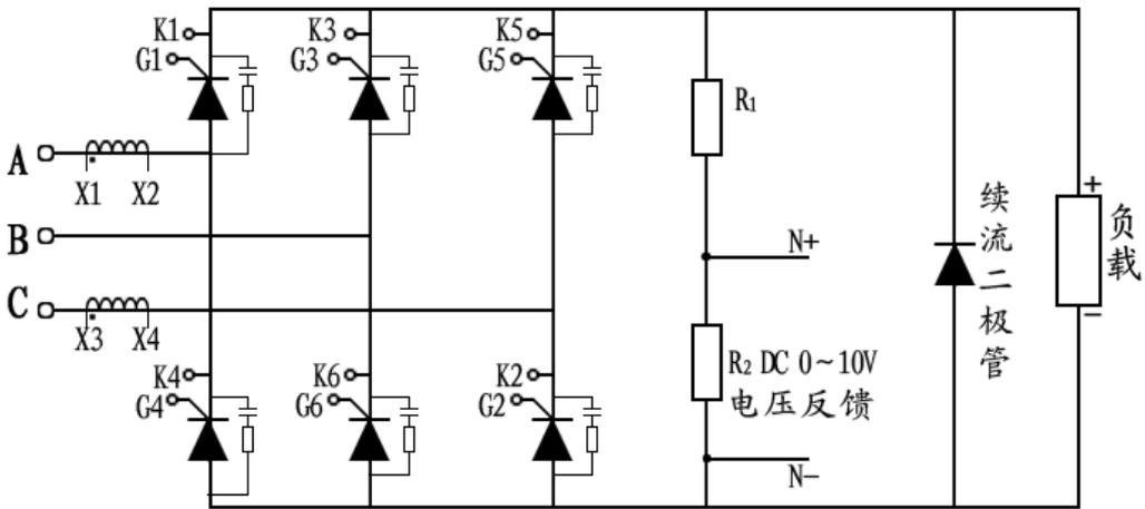
图 4-3-1 三相全控桥式整流调压接线图
