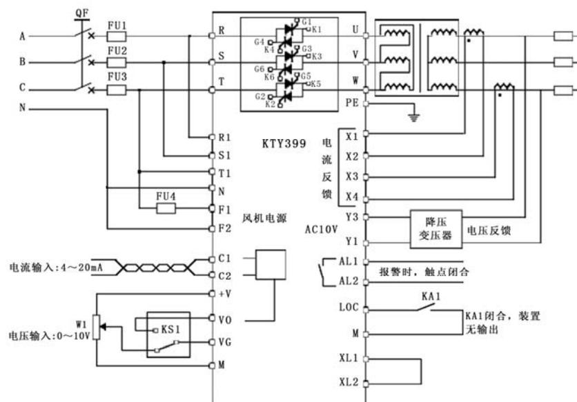
图4-4-2 KTY399应用于低电压、大电流负载的电压闭环控制
