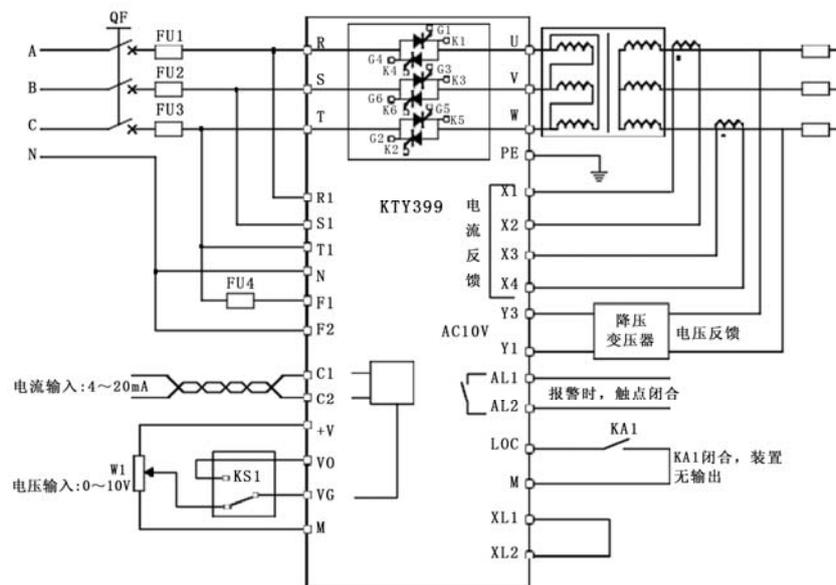
图4-4-3 KTY399应用于低电压、大电流负载的电流闭环控制
